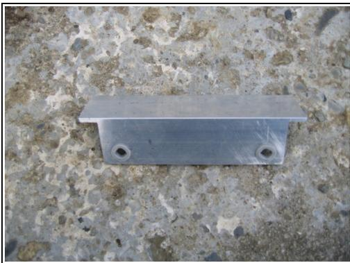
◀ Pièce de fixation capteur avec protection galvanique (tampons
