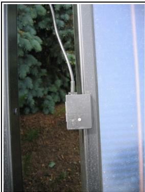
◀ Solarimètre dans le plan des capteurs
